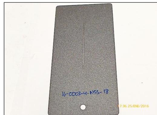
(d) Probeta "16-0003-4-18", destinada a ensayo **NSS UNE-EN ISO 9227:2012**, una vez realizada la incisión sobre la cara pintada.
