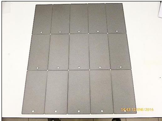
(a) Probetas destinadas al ensayo **NSS UNE-EN ISO 9227:2012**.
