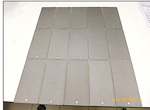
(b) Probetas destinadas al ensayo **CH UNE-EN ISO 6270-2:2006**.
