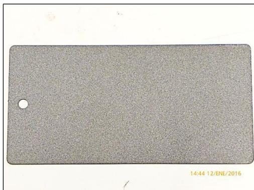
(c) Probeta "16-0003-4-18", destinada a ensayo **NSS UNE-EN ISO 9227:2012**.
