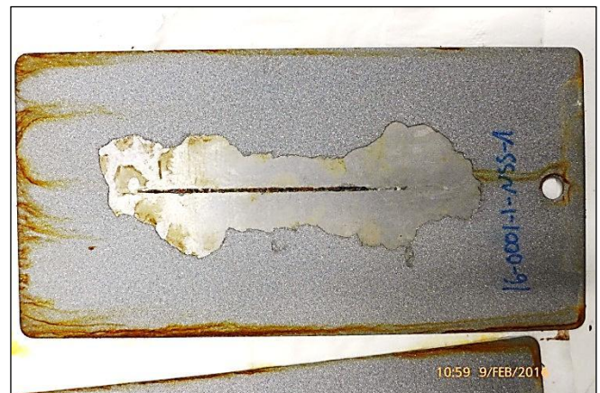
(b) Probeta "16-0001-1-31", detalle zona de incisión después de delaminación, una vez finalizado el ensayo.
