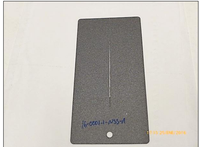
(b) Probeta "16-0001-1-31", una vez realizada la incisión sobre la cara pintada
