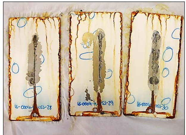
(b) Probetas "16-0004-4-28", "16-0004-4-29" y "16-0004-4-30", detalle de "grado de corrosión" desde zona de incisión después de delaminación y/o decapado, una vez finalizado el ensayo.
