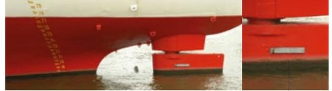
**El zinc: elemento clave para combatir la corrosión.** El zinc se utiliza en la industria naval para la protección del acero. Se instalan **ánodos de zinc** cerca de la unión de distintos metales para que actúen a modo de sacrificio en el proceso de oxidación. Al ser menos noble que el acero, el zinc cederá sus partículas protegiendo la estructura de acero.
